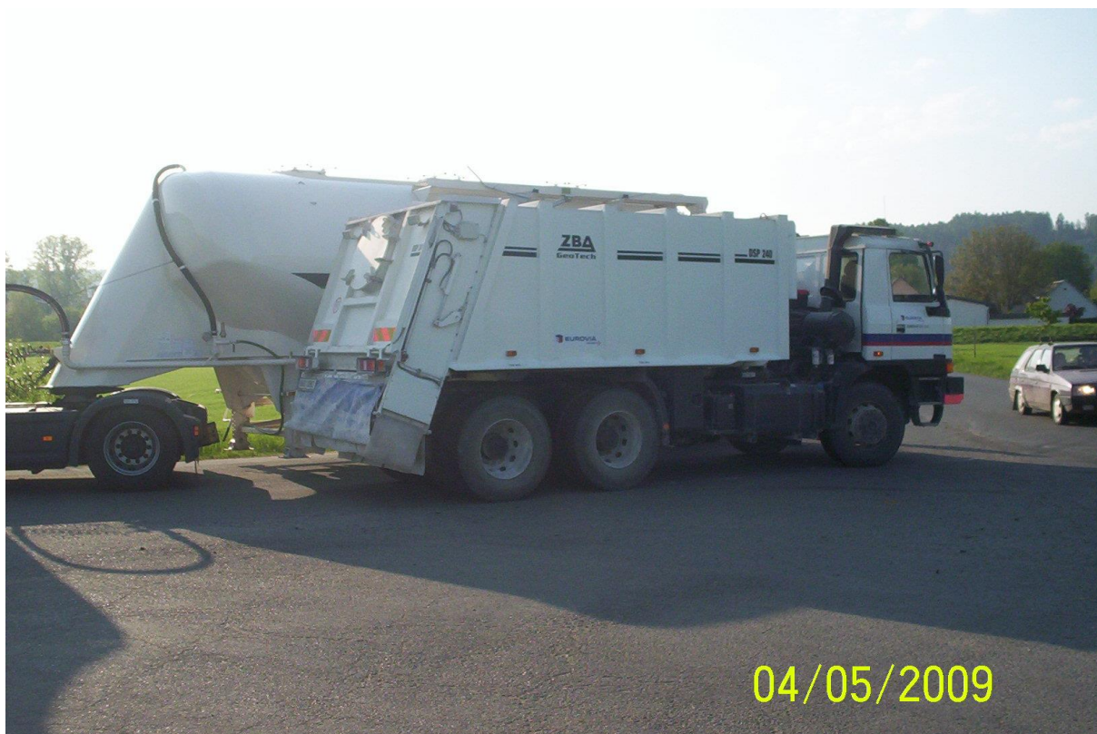
Aplikátor pojiva a za ním autocisterna s pojivem RSS 5 – provozní zkouška v železniční stanici Bludov
